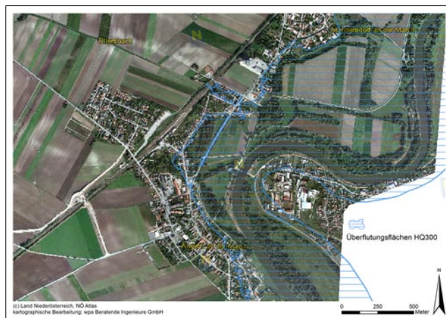
Abb. 4: Überflutungsflächen bei einem 300 jährlichen Hochwasser in Angern an der March.
