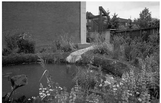
Abb. 1: Abkopplung von Regenwasser, hier in Bottrop auf einem Kirchengelände, entlastet das Kanalnetz, stärkt den lokalen Naturhaushalt und gestaltet attraktive Flächen.
